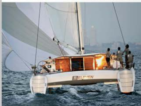
Raldeer. La plate-forme se déforme peu et, bien chargée sous spi, la coque au vent commence à soulager.
